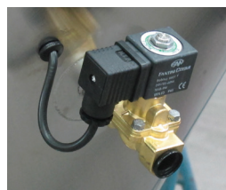
Vanne de régulation de débit : électrovanne avec connecteur et bobine (pour chaque cuve)
